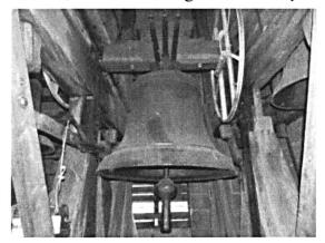
der dynamischen Eigenschaften und der Beanspruchungen an der Glocke beim Läuten wurde eine Anschlagsintensität von  $J_{exp} = 4,1$  ermittelt, die im Wesentlichen aus einer ungünstigen Massenverteilung am Klöppel resultierte.
