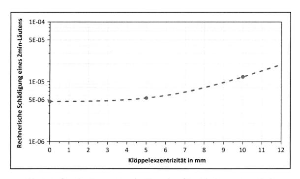
Abb. 6: Einfluss der Exzentrizität des Klöppels auf die Schädigung einer Glocke  $(\emptyset \approx 1 \text{ m})$
