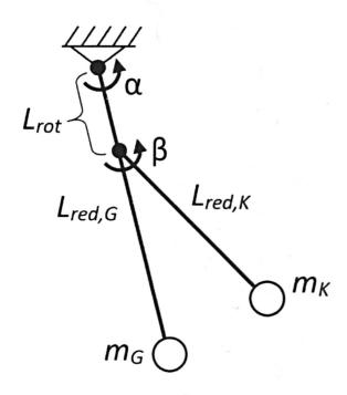
Abb. 1: Das Doppelpendelsystem einer Glocke
