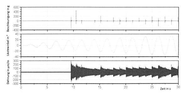
Abb. 5: Prellschläge beim Einläuten: Anschlagsintensität und Beanspruchung der Glocke
