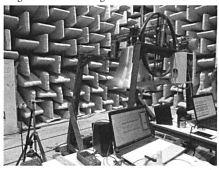
Abb. 4: Läutemessung an einer Glocke mit verkröpftem Joch im Schalllabor
