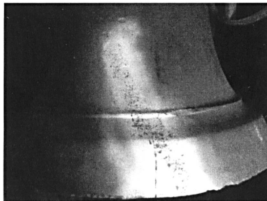
Abb. 9: f'-Glocke der Michaelskirche in Entringen mit erneutem Riss in Schweissung
