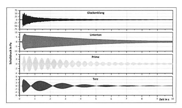
Abb. 7: Abklingverhalten einer Glocke sowie ausgewählter Teiltöne (gefiltert)
