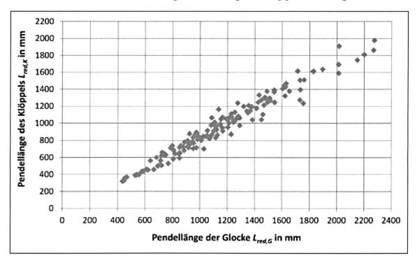
Abb. 2: Verhältnis der reduzierten Längen von Glocken- und Klöppelpendel von etwa 150 untersuchten Glockensystemen
