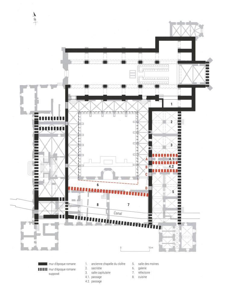
Fig. 7 Plan du couvent roman (en noir), avec les murs attestés (trait plein) et supposés (traitillé) ainsi que les espaces liés aux ouvertures A, B, C et D (en rouge)
