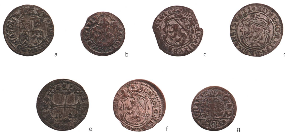
Abb. 14 Herstellungsfehler, a) tiefen Rillen (Kat. 85, Vs.); b) Fehlstanzung (Kat. 78, Rs.); c) Zainränder (Kat. 21, Vs.); d) Überprägungsspuren und geänderter Stempel (Kat. 16, Vs.); e) geänderter Stempel (Kat. 80, Rs.); f) dezentrierte Prägung (Kat. 25, Vs.); g) tupfenartige Erhebungen (Kat. 145, Vs.)
