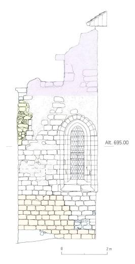
**Fig. 18** Relevé de l'épaulement sud de la nef, avec la fenêtre subsistant de l'étage ajouté sur le dortoir
