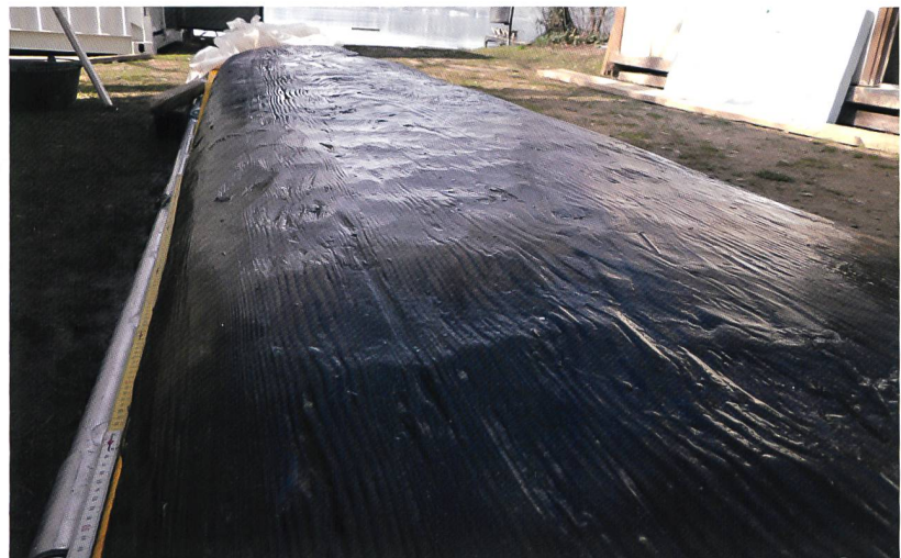
Fig. / Abb. 13 Traces de façonnage sur la surface interne de la coque Herstellungsspuren an der Innenseite des Schiffsrumpfs
