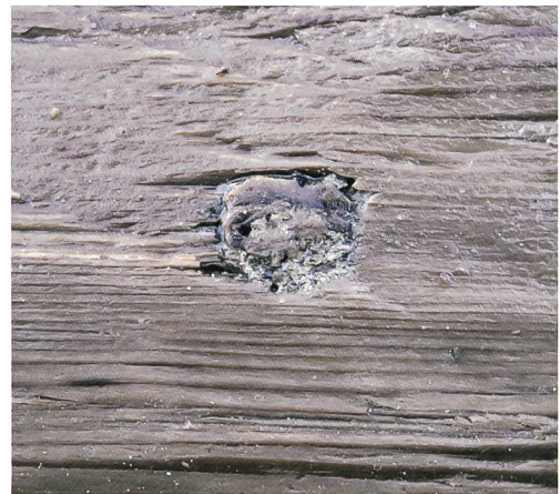
Fig. / Abb. 11 L'une des chevilles de bois insérées dans la coque Einer der in den Schiffsrumpf eingelassenen Holzzapfen
