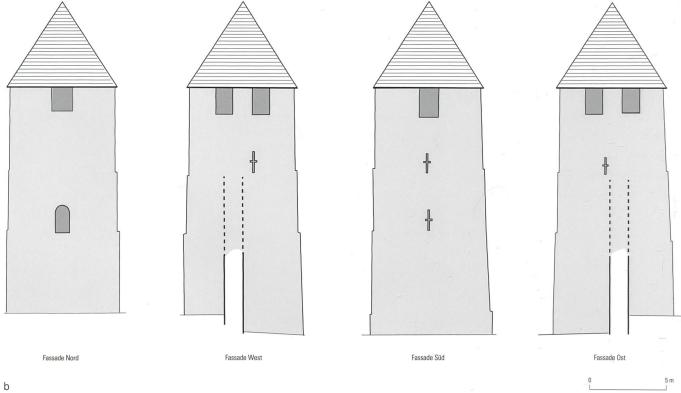
Abb. 4 Aussenansichten des Turms: a) heutiger Zustand mit Eintragung der verschiedenen Bauphasen; b) Turm zur Bauzeit
