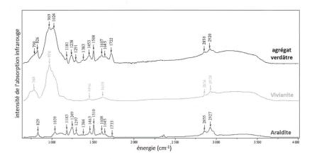
le degré d'absorption en fonction de l'énergie du rayon. Il en résulte un spectre FT-IR, un ensemble de pics d'absorption d'intensités différentes dans une gamme de longueurs d'onde définie.
