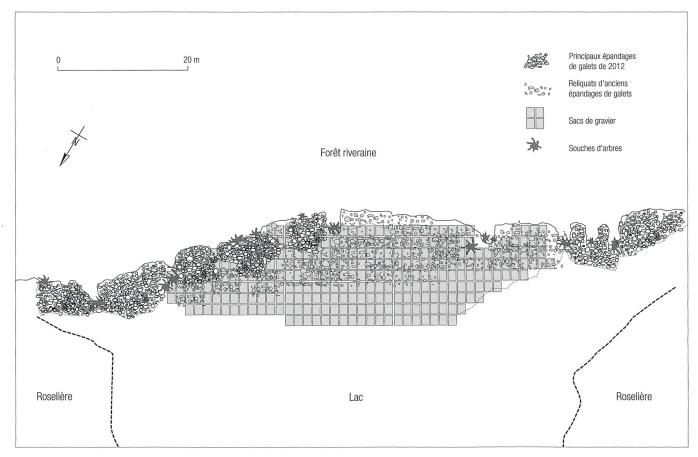
Fig. 2 Plan général des rives de la station de Font, avec les épandages de galets réalisés en 2012
