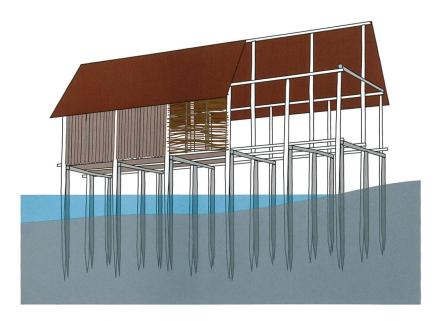
Pour pallier ces handicaps, plusieurs solutions techniques existent, mais elles ne sont de loin pas infinies. Au bord de nos lacs et dès le Néolithique, les populations, pour lutter contre les problèmes d'humidité récurrente du sous-sol, ont pu avoir recours à deux systèmes différents: rehausser le plancher des maisons en adoptant le principe d'une architecture aérienne, ou construire à même le sol mais en créant une isolation artificielle.
