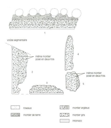
Fig. / Abb. 7 Tableau des mortiers et des angles: 1 enduit de la voûte surbaissée avec empreintes de roseaux; 2 angle reliant la voûte surbaissée à la plate-bande; 3 enduit de la plate-bande: 4 enduit du sommet de la paroi; 5 Enduit de la paroi Bildtafel zu Mörteln und Winkeln: 1 Verputz vom Deckengewölbe mit Abdrücken von Schilfrohr: 2 Winkel am Übergang vom Seitenband zum Gewölbe; 3 Verputz vom Seitenband; 4 Verputz vom oberen Abschluss der Wand; 5 Verputz von der
