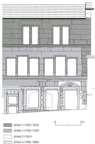
Fig. 12 Fribourg/Place du Petit-Saint-Jean 9. Relevé de la façade avec les phases de construction
