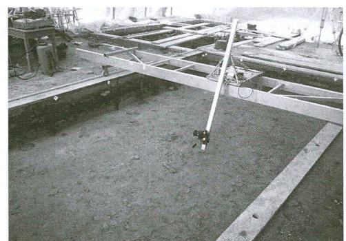
Fig. / Abb. 9 Système de relevé photographique avec potence sur rail (utilisation ici pour les profils) Kamerainstallation mit Arm und Gleitschiene (hier eingestellt zum Fotografieren der Profile)
