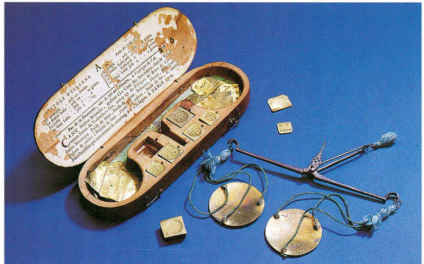
Fig. 1 Boîte renfermant la balance, les poids monétaires et les lamelles de grains
