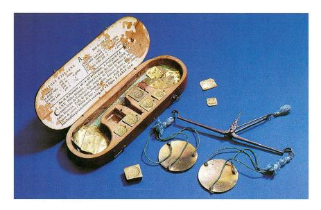
Fig. 1 Boîte renfermant la balance, les poids monétaires et les lamelles de grains
