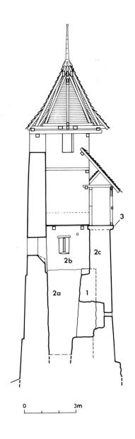
Abb. 77 Murten/Ringmauer. Schnitt durch Pfaffenturm und Ringmauer; 1) Ringmauer des 13. Jh.; 2a) Sockel des Turmes, 1358?; 2b) Oberer Teil des Turmes, 1396-1401; 2c) Aufdoppelung und Aufstockung der Ringmauer, 1392-1399; 3) Gedeckter Wehrgang, 1432 (1:150)
