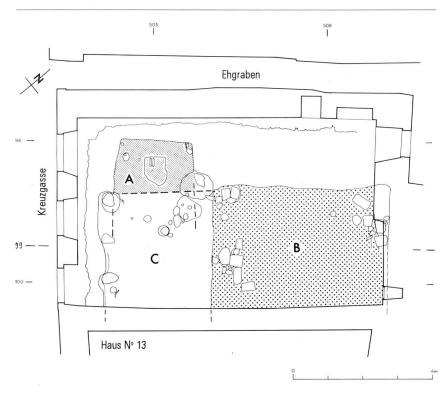
Abb. 64 Murten/Kreuzgasse 11. Grundriss der Bauphasen 1 und 3: A) der erste Keller (Ende 12./Anfang 13. Jh.); B) der zweite Keller (1240-1300); C) der dritte Keller (1250 - 1325) (1:100)
