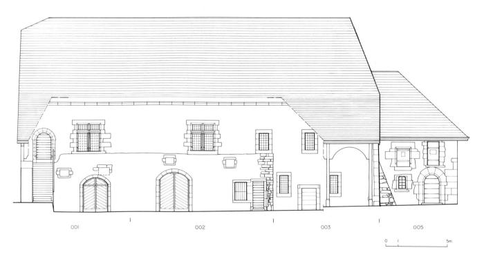
Fig. 136 Romont/Château. Relevé de la façade sur cour de l'aile nord; les chaînages d'angle restituent les limites des chantiers de construction successifs
