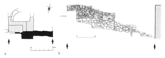
Fig. 102 Gruyères/Château. a) plan de la deuxième phase (en noir); en gris: les troisième à cinquième phases; en blanc: la première phase; b) élévation du parement nord du mur nord; en blanc: la deuxième phase; en gris: les cinquième et sixième phases (1:100)
