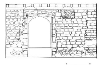
Fig. 134 Romont/Château. Relevé au pierre-à-pierre du mur sud de la salle 001. La porte a été percée vers 1542, en coupant deux petites fenêtres du XIII<sup>e</sup> siècle (1:100)
