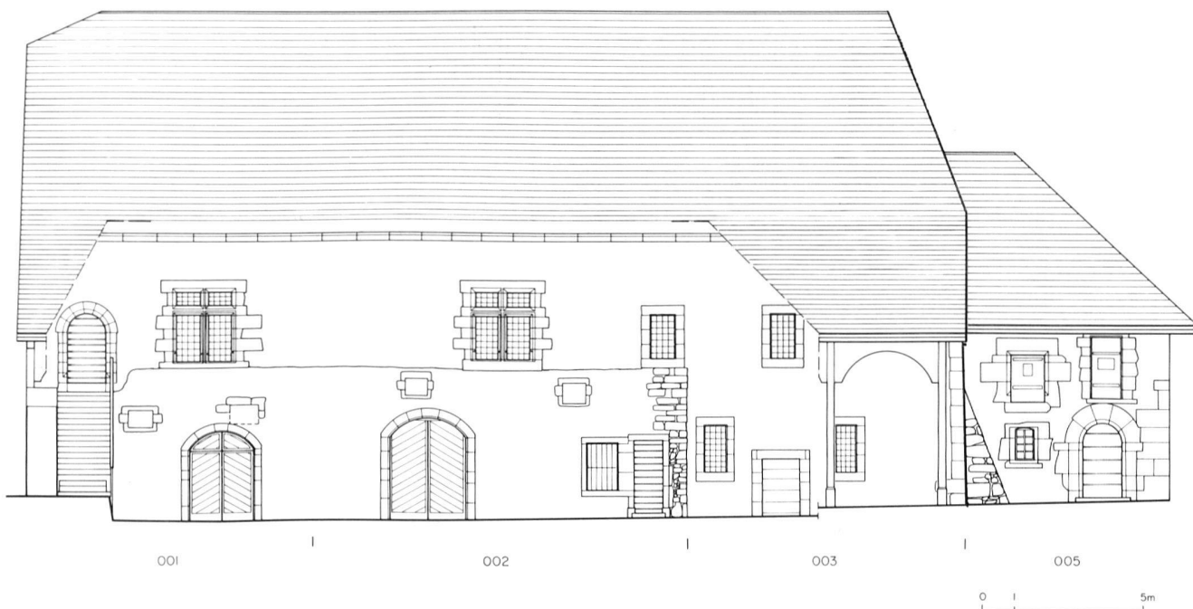
Fig. 136 Romont/Château. Relevé de la façade sur cour de l'aile nord; les chaînages d'angle restituent les limites des chantiers de construction successifs
