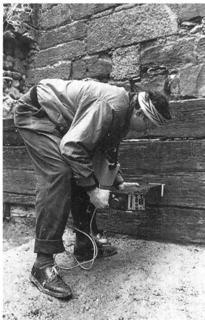
Fig. 83 Fribourg/R. de Romont. Evaluation de l'état de conservation du bois (coursive de 1468) pour déterminer les traitements à adopter
