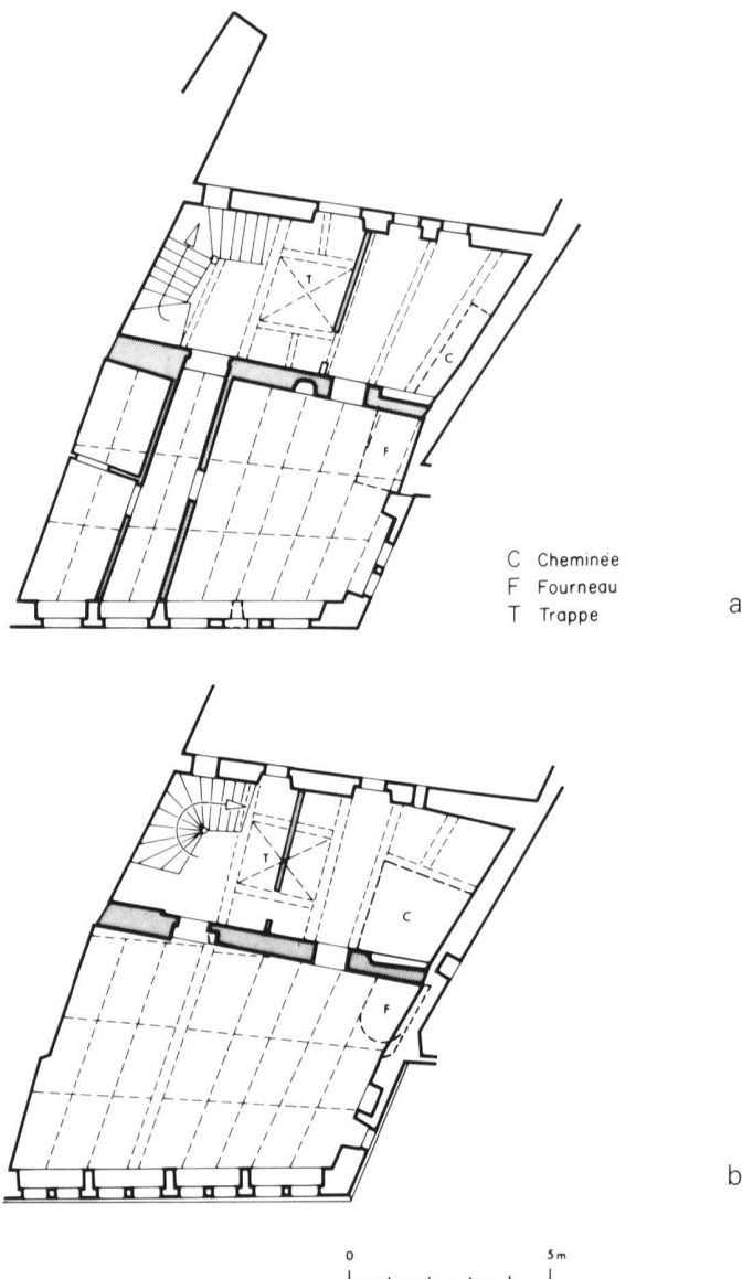
Fig. 48 Fribourg/Petit-St-Jean 35-37. N° 37, plan de l'intérieur avant les travaux (état de la fin du XVI e siècle en gris); a) rez-de-chaussée; b) premier étage (1:200)
