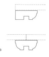
Fig.52 Fribourg/Petit-St-Jean 35-37. Nº 37, profils des couvre-joints des plafonds à caissons; a) rez-dechaussée; b) premier étage (1:4)
