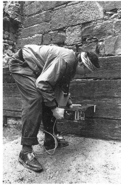
Fig. 83 Fribourg/R. de Romont. Evaluation de l'état de conservation du bois (coursive de 1468) pour déterminer les traitements à adopter
