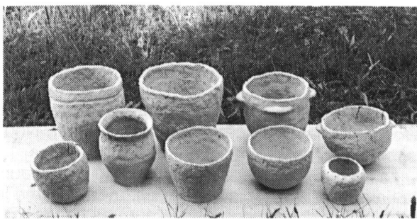
Fig.8 Séchage des récipients avant cuisson
