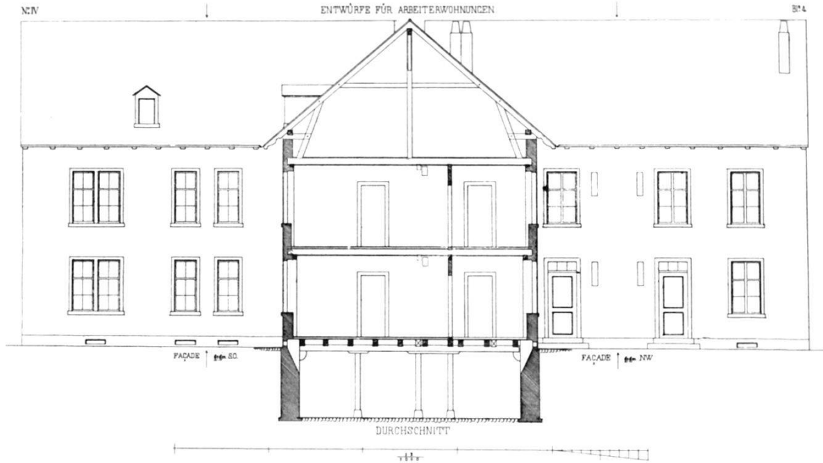
Abb. 7. Entwurf J.J. Steblin d. Ä., 1853, (Prototyp) Schnitt|Ansichten (aus: Über Arbeiterwohnungen in und um Basel, Blatt 4).
