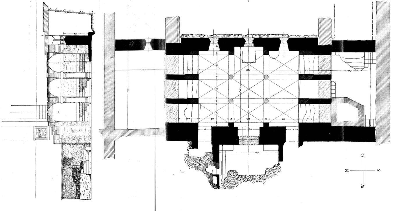
Grundriß, Längsschnitt und Querschnitt der Krypta 1 : 100.
