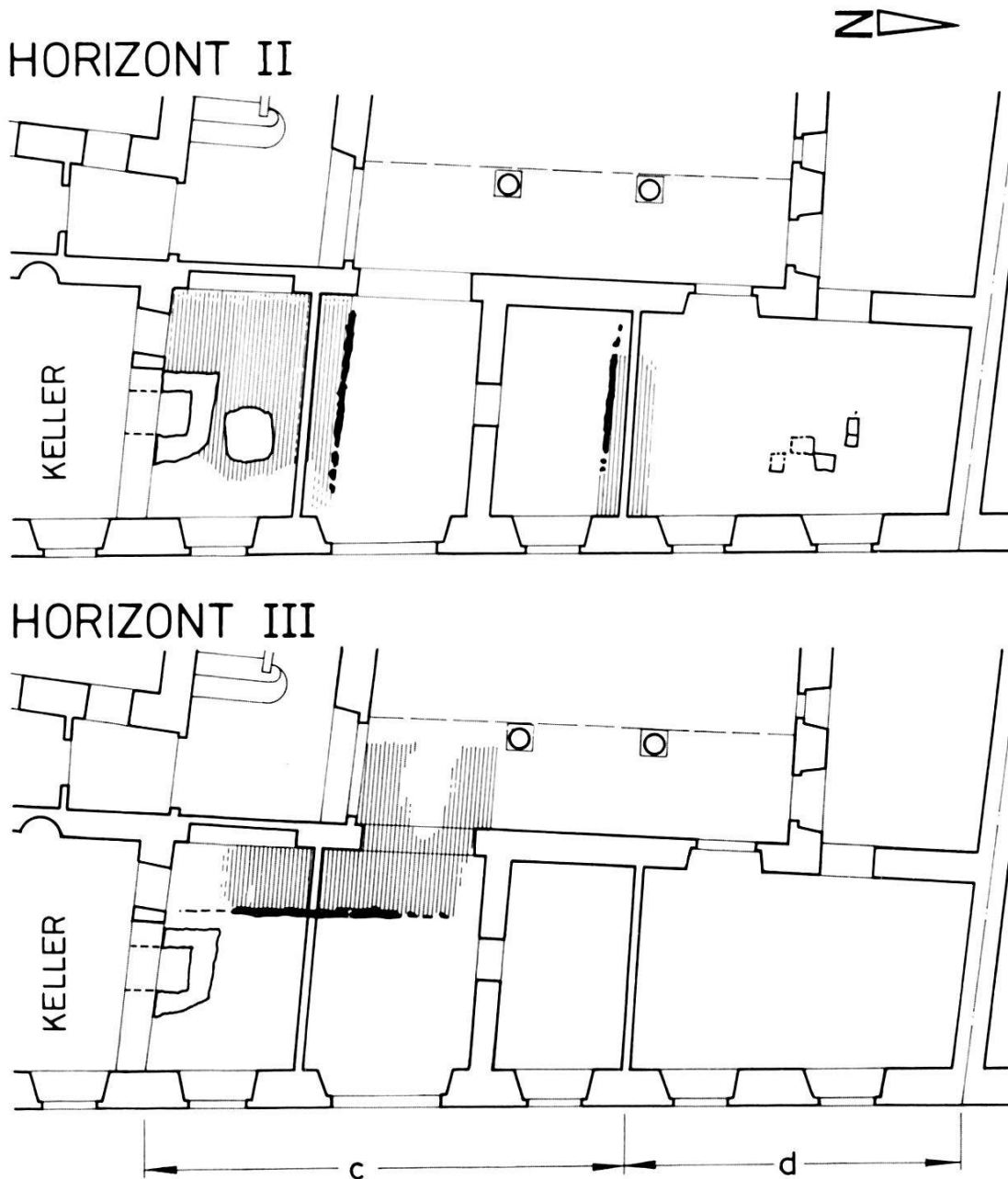
Abb. 32. Nadelberg 20, 1985/31, alter Rosshof. Planskizze der Holzbauten der Siedlungshorizonte II und III in den Holzbauzonen Abb. 30,c,d. Schwarze Linien: Steinlagen als Unterlage zu Schwellbalken, Raster: Lehmeistrich der Holzbauten. Vierecksignatur: Gruben. – Zeichnung: Ch. Bing. – Massstab 1:200.
