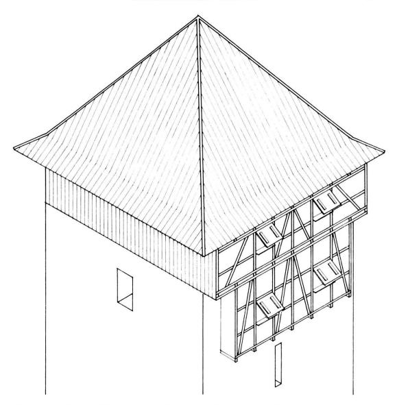
Abb. 55. St. Johann-Tor. Rekonstruktionsversuch der ursprünglichen Turmbekrönung. – Zeichnung: Basler Denkmalpflege.
