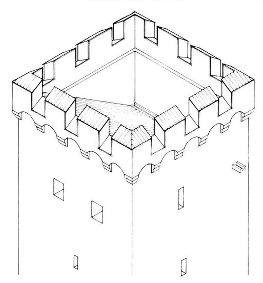
Abb. 56. St. Johann-Tor. Rekonstruktion der Turmkbekrönung nach dem Umbau von 1582. – Zeichnung: Basler Denkmalpflege.
