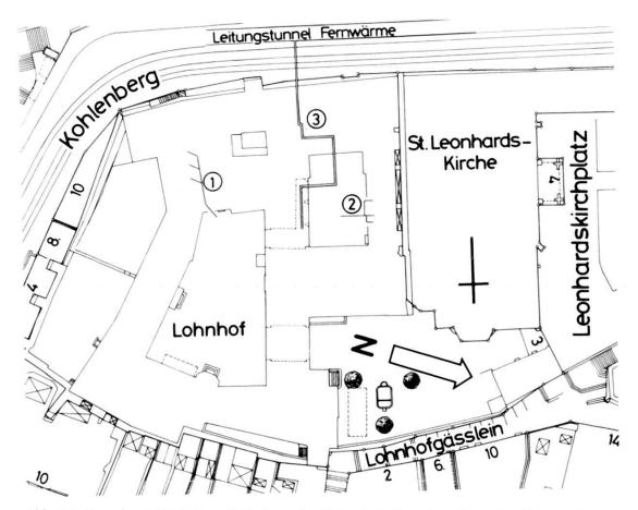
Abb. 24. Leonhardskirchplatz 3 (Lohnhof), 1984/14. Situationsplan. 1 = Wasserleitung im Zellentrakt, 2 = Wasserleitung im Innenhof, 3 = Fernheizungskanal. – Zeichnung: E. Albrecht. – Massstab 1:1000.
