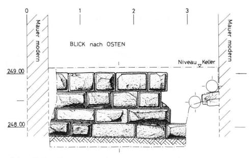
Abb. 6. Fischmarkt 1/Tanzgässlein 3, 1981/16. Ansicht der Bossenquadermauer, d.h. der Westseite von Mauer 2 (entspricht P 5a auf Abb. 5). – Zeichnung: T. Reiss. – Masssiab 1:50.
