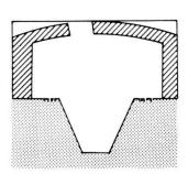
Abb. 6. Riehen – Rössligasse 51: Eiskeller hinter dem Pavillon auf dessen Nordseite. Oben: Aufsicht auf die steingefaßte Eisgrube. Unten: schematischer Grundriss und Querschnitt durch den Eiskeller mit der Gewölbeluke und der Eisgrube. Gezeichnet E. Weber. Maßstab 1:50, beziehungsweise 1:200.
