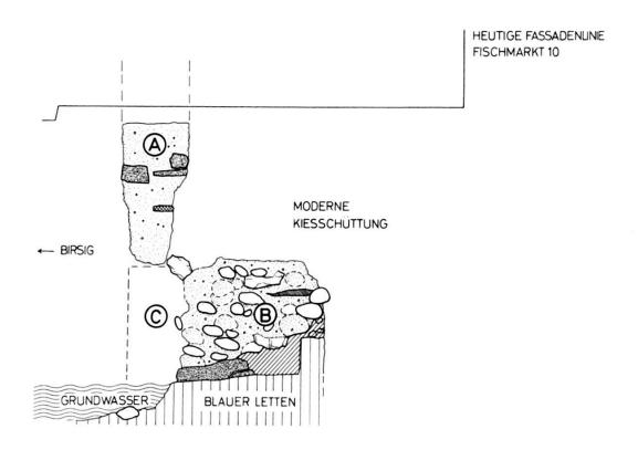
Abb. 3. Fischmarkt 10: Ruine einer Wehrmauer. A = Fundament der alten Haus-fassade. B = Kern aus Flußkieseln zu einer Wehrmauer oder Flußverbauung. <math>C = hypo-thetische Umrißlinie der Sandsteinverkleidung der Sichtseite. Gezeichnet E. Weber. Maßstab 1:50.
