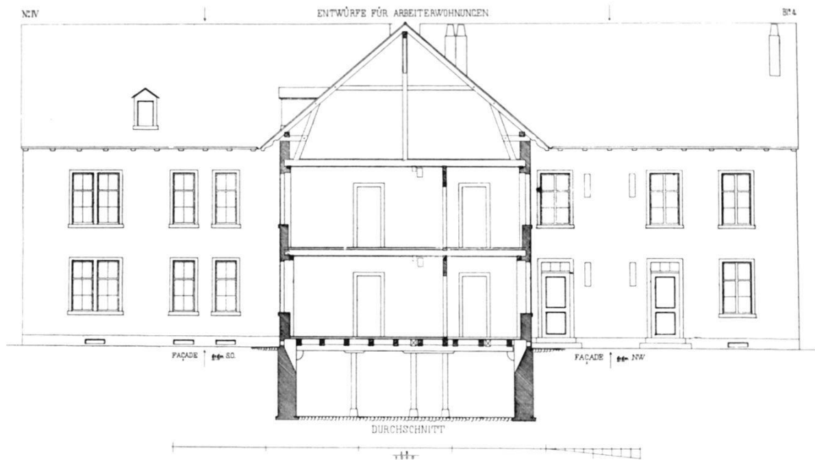
Abb. 7. Entwurf J.J. Stehlin d. Ä., 1853, (Prototyp) Schnitt|Ansichten (aus: Über Arbeiterwohnungen in und um Basel, Blatt 4).
