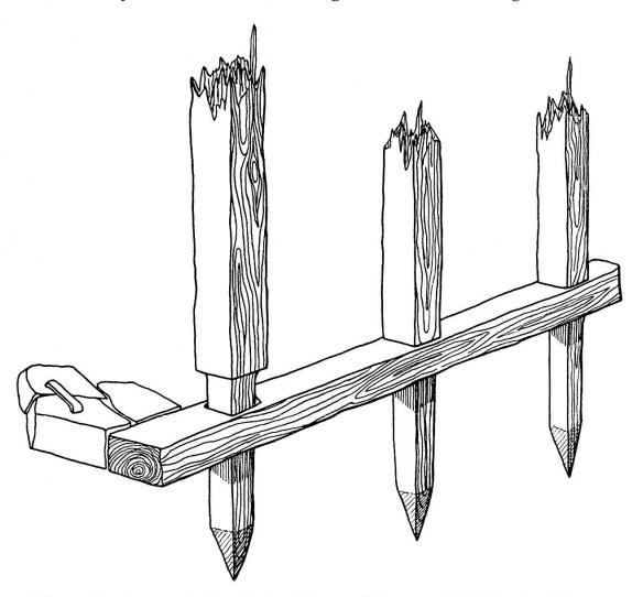
Abb. 11. Brückenreste bei St. Jakob: Rekonstruktionsversuch des Brückenpfeilers mit Schwellenbalken. Entwurf R. Moosbrugger-Leu, gezeichnet von W. Geiger.
