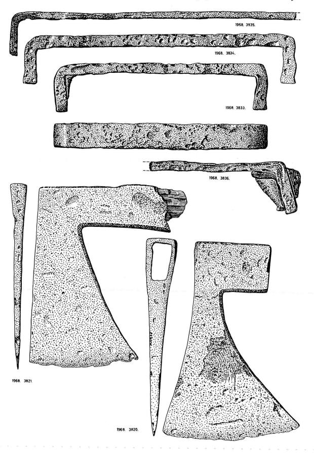
Abb. 13. Brückenreste bei St. Jakob 1968, 1969. Oben: eiserne Verbindungsklammern zu den Steinquadern; an den eingelassenen Enden zum Teil noch Bleireste. Unten: zwei Zimmermannsäxte. Gezeichnet von W. Geiger. Maßstab 1:3.
