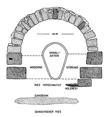
Abb. 5. Steinenschanze: Überwölbung des Steinenbaches bei der Schanze. Die Sandschicht markiert den älteren Lauf vor der Überwölbung beim Bau der Steinenschanze.
