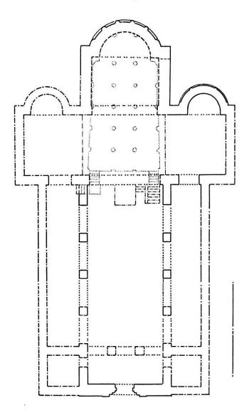
Abb. 5. Schänis, ehem. Stiftskirche; Zustand zu Beginn des 12. Jahrhunderts, Rekonstruktionsversuch (Kryptatreppen in zwei Varianten) aufgrund eines Planes bei J. R. Rahn (A. Gaudy), 1:400.
