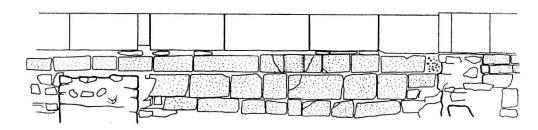
Abb. 7. Münster, Georgsturm: Auf- und Ansicht der Fundamentpartie. (Der Pfeil markiert den Blickwinkel der Photographie auf Tafel IV). Gezeichnet von M. Rudin, Maßstab 1:80.
