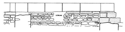
Abb. 8. Münster, Martinsturm: Auf- und Ansicht der Fundamentpartie. (Der Pfeil markiert den Blickwinkel der Photographie auf Tafel IV). Gezeichnet von M. Rudin, Maßstab 1:80.
