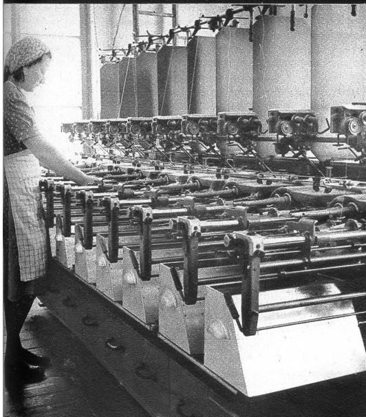
Die automatische Eintrag-Spulmaschine erstellt die Bobinen für die Weberschiffli
