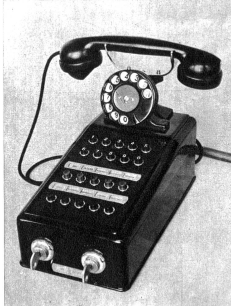
Der Hauptapparat des „Ipsophon“ weist, der Wählscheibe zunächst, 10 Tasten (1—9 und 0) auf; es sind die Geheimschlusstasten. Die nächste Tastenreihe bedient die Funktionen des Ipsophons und des Telefons gleichzeitig und die unterste Reihe setzt das Aufzeichnen von Meldungen, das Abhören, das Wiederholen des letztgehörten Satzes, das Löschen der aufgezeichneten Gespräche und die Rückfrage bei Haustelesonanlagen in Funktion. Der Schlüssel links sperrt das Geheimschloss, derjenige rechts die internen Tasten
