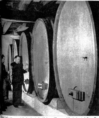
Ständige und fachmännische Ueberprüfung verbürgt eine tadellose Qualität. — Rechts: Die sichtbaren Standmesser an den Zementfässern erlauben eine genaue Nachprüfung des Inhalts
