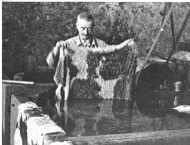
Das Entfernen der Fleischteile von der Haut Unten: Das Weichen der Rohhäute
