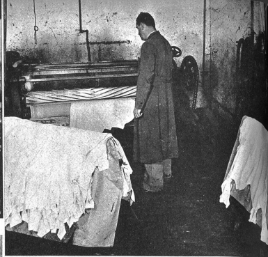
Das weisse Leder (eine Spezialität der Gerberei) wird nach der Gerbung sorgfältig geglättet
