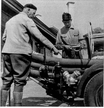
Eine der Schenk-Motorspritzen wird eingehend einer Musterung unterzogen; die Erfahrungen gehen schon an die fünfte Generation über
