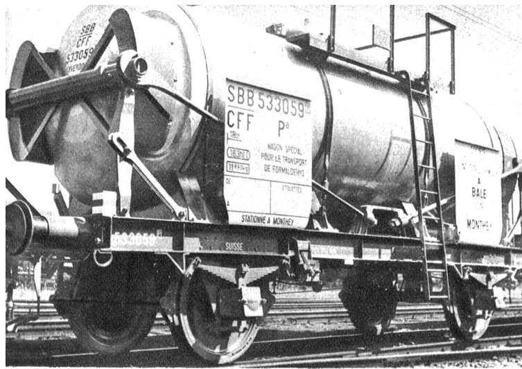
Oben links: Die Schweizerischen Bundesbahnen haben einen neuen Tankwagen in Dienst gestellt, bei dessen Spezialkonstruktion der Tank im Wagen hängt. Der Wagen wird speziell für den Transport von Formaldehyd verwendet. Oben rechts: Die Schweizer Schützen-Nationalmannschaft hat im Fern-Länderkampf gegen Schweden, der zugleich in Thun und in Stockholm ausgetragen wurde, einen heiss umstrittenen, viel umjubelten Sieg davongetragen. Unser Bild zeigt (von links nach rechts): Gruppenchef König, Ex-Weltmeister Dr. Schnyder, Simmen, Brand, Zimmermann, Hartmann, Teilenbach, Horber, Schlapbach, Grünig
