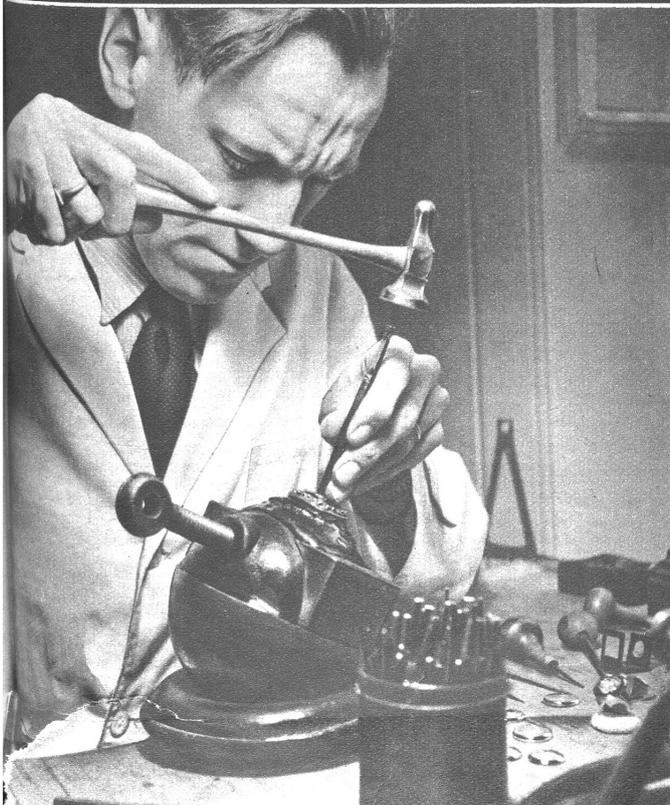
Links: Das Ziselieren der Schmuckstücke ist eine sehr feine und delikate Arbeit. Das empfindliche Metall darf in keiner Weise verletzt werden, sondern es muss, trotz der schwer wirkenden Werkzeuge, äusserst vorsichtig bearbeitet werden.
