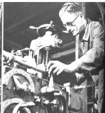
Stahlwellen werden an der Kalkkreissäge zugehoben
