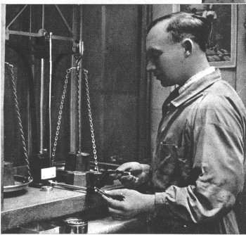
Auf der Prüfwaage. Mit der Pinzette werden bis zum exakten Gewicht Schrotkörner zugegeben, dieselben sodann der Kernmasse beigestampft, worauf die Stempelung erfolgt.
