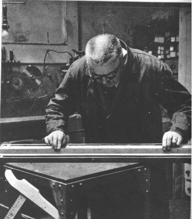
Links: Eine zünftige Belastungsprobe. Kontrolle eines hölzernen Meterstabes (sogen. Handtismeter) durch Auflagen auf den metallenen Normalmeter (im Holzset).
