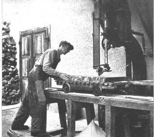
Die Dicke der zugeschnittenen Blöcke entspricht der Holzbodenbreite.
