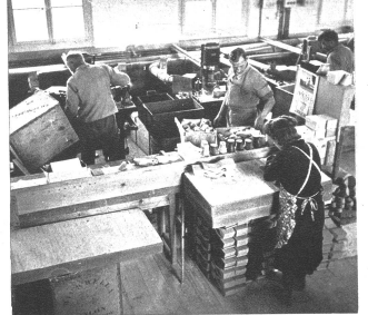
Mittels Schablonen werden auch die Korkplatten möglichst rationell ausgenützt.
