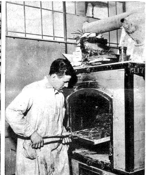
Bei ca. 650—700 Grad verbindet sich das Schwarzlot, die aufgemalte Farbe, mit dem Glas. Es ist aber sehr darauf zu achten, dass dabei das Glas, das bei ca. 1200 Grad schmilzt, nicht zu weich wird.
