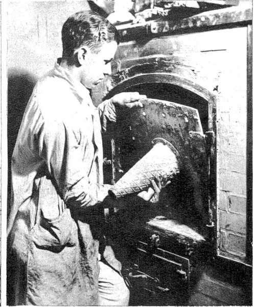
Die Ofentüre wird sorgfältig verschlossen und mit Lehm abgedichtet. Mit Holzfeuerung wird er allmählich auf eine Temperatur von ca. 650—700 Grad gebracht.
