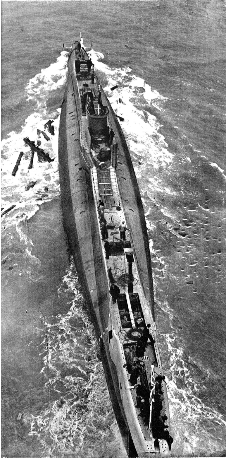
Stapellauf des englischen Unterseebootes „Taku“ in Birkenhead-Liverpool. Im Wasser die Stützen des U-Bootes, die beim Stapellauf beiseite gedrängt wurden.
