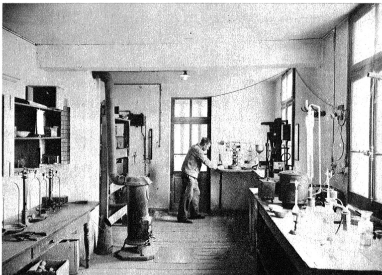
Im physikalischen Laboratorium wird der fertige Zement auf Festigkeit und Volumenbeständigkeit geprüft.
