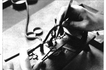
Apparat zum Einsetzen des Ankers in einer Uhr, Omega, Biel.
