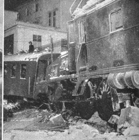
Unter den Rädern der Lokomotive sieht man die Trümmer des Prellbockes (ATP)
