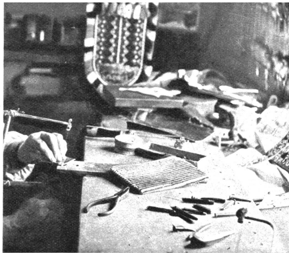
Oben links: Das Aussägen der auf der grossen Messingplatte angezeichneten Stücke zu Kühen, Sennen, Rosen und anderem. Oben rechts: Die ausgesägten Figuren werden nachgestanzt, ausgefeilt und poliert. Rechts: Alles Handarbeit: der Messingbeschlag der farbigen Pergamentsstepperei und die farbenfrohen Fransen und Zöpfe
