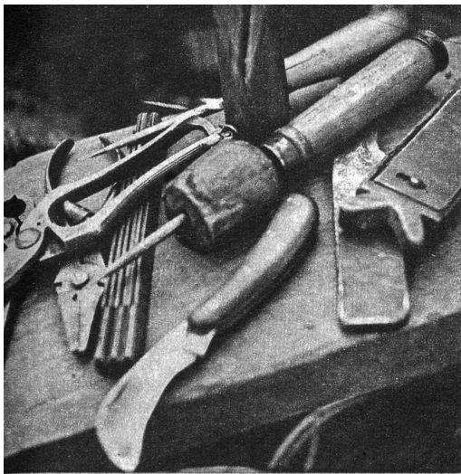
Werkzeuge des Korbers: Zangen, Schere, Hobel, scharfes Weidenmesser, Weidenspalter, Ahlen und anderes mehr
