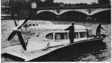
In Paris erregt derzeit ein neuartig konstruierter Hydroplan Aufsehen. Er ist von Le Hävre in die französische Metropole gesteuert worden. Er fasst 22 Passagiere neben zwei Mann der Besatzung und erreicht Spitzengeschwindigkeiten von über 93 km in der Stunde.
