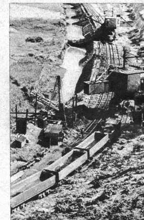
Die Gewinnung von Oelschiefer entlang den Ostseeküsten ist ein altes Gewerbe und wird heute maschinell betrieben. Oelschiefer wird zur Oelgewinnung gebrochen
