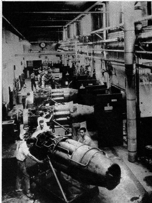
Der Düsenmotor spielt in der amerikanischen Militärvliegtechnik eine immer grösser werdende Rolle. Der einstweilen gebräuchlichste Typ ist der TG-180, der wie ein Torpedo aussieht und bei 2-, 4-, 6- und 8motorigen Kampf- und Bombenflugzeugen Verwendung findet. Hier werden solche Motoren in die Versuchskammern der General Electric's Aircraft Gas Turbine-Fabrik (Neuyork) gebracht, bevor sie nach den verschiedenen Flugzeugfabriken des Landes versandt werden
