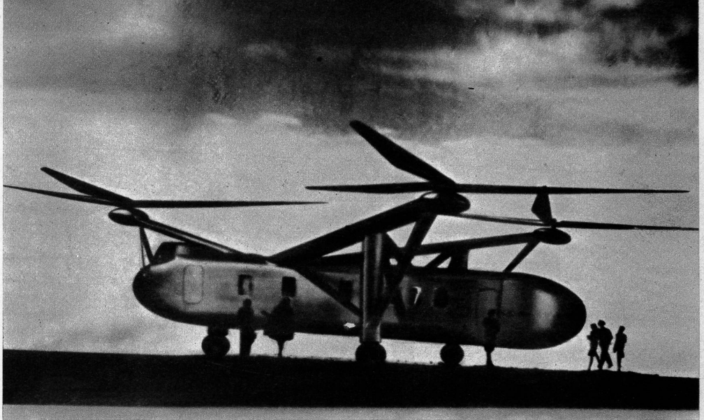
Wieder ein neues Luftungeheuer: Drachenhafte und gespenstisch mutet dieser neue Helicopter an, der im nächsten Frühling in England seinen ersten Flugversuch unternehmen wird. Drei Horizontal-Propeller, ein 1640-PS-Motor und ein salamförmiger Rumpf sind die reichlich kuriosen «Zutaten» dieses Flugzeuges, das 24 Personen und drei Tonnen Fracht mit sich führen kann.
