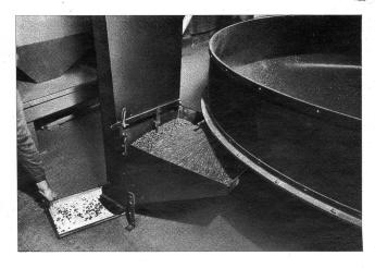
Der abgekühlte Kaffee wird abgelassen. Er passiert vorerst den Entsteiner, durch welchen Steinchen, Fremdkörper usw. ausgeschieden werden. Auf pneumatischem Weg wandert der gereinigte Kaffee dann in die Silos der Speditions-Abteilung
