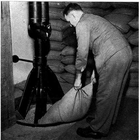
Von hier wandert der Roh-Kaffee mittels der pneumatischen Anlage in die grossen Rösttrommeln
