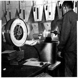
Der geröstete Kaffee verlässt die grossen, luftdicht verschlossenen Silos, wird auf einer fahrbaren Waage gewogen und dann für die Spedition bereitgemacht
